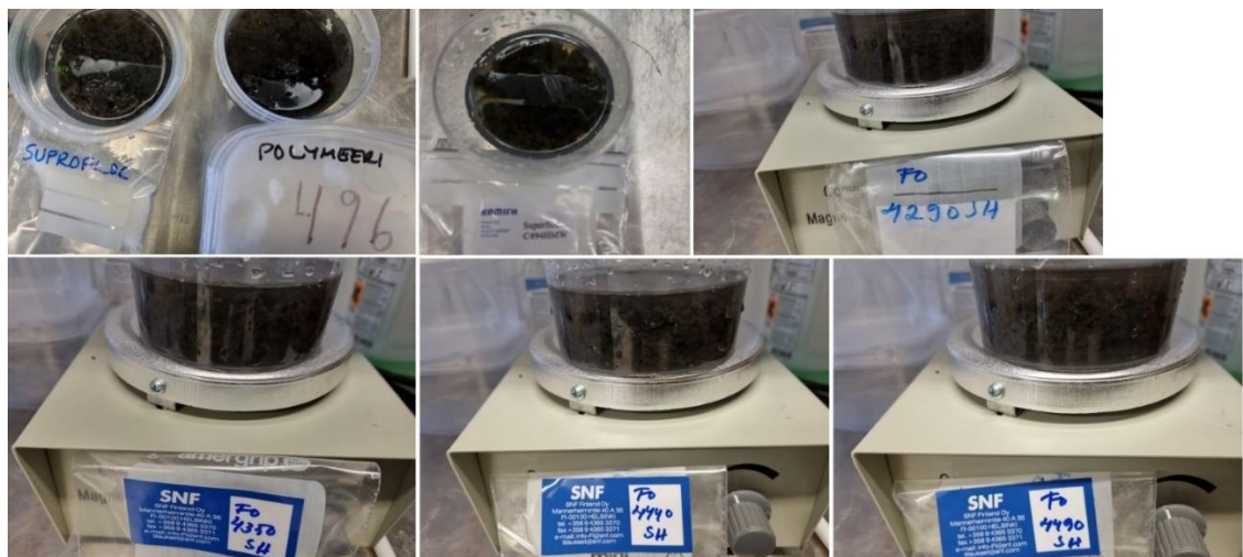
Kuva 10. Parhaiten toimineet polymeerit Suproflocc, Superfloc C496HMW, Superfloc C494HMW, FO 4290 SH, FO 4350 SH, FO 4440 SH ja FO 4490 SH laskeutuksen jälkeen sakeassa palautuslietteessä.
