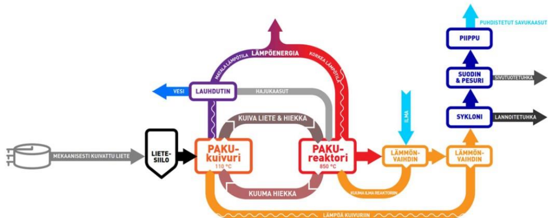
Kuva 5. Yksinkertaistettu kuvaus PAKU-tekniologiasta (Laasonen 2020)
