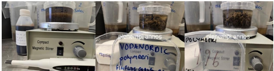
Kuva 16. Sakeamman palautuslietteen flokkaaminen Haarlan tanniini-biopolymeerillä, ja perinteisillä Vodanordicin FINFLOC:illa ja Kemiran Superfloc C496HMW:lla.
